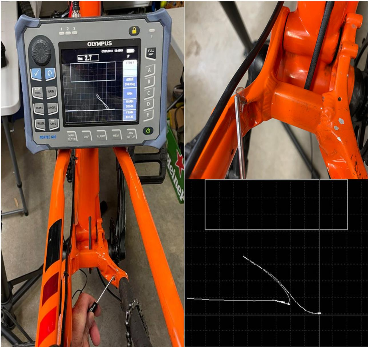
Scansione eddy current di un'area soggetta a cricche su un telaio di bicicletta usando il rilevatore di difetti eddy current NORTEC 600.
